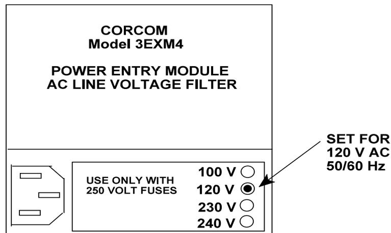
**AC LINE FILTER FOR RACK MOUNTED SERIES 5000 SYSTEMS**
